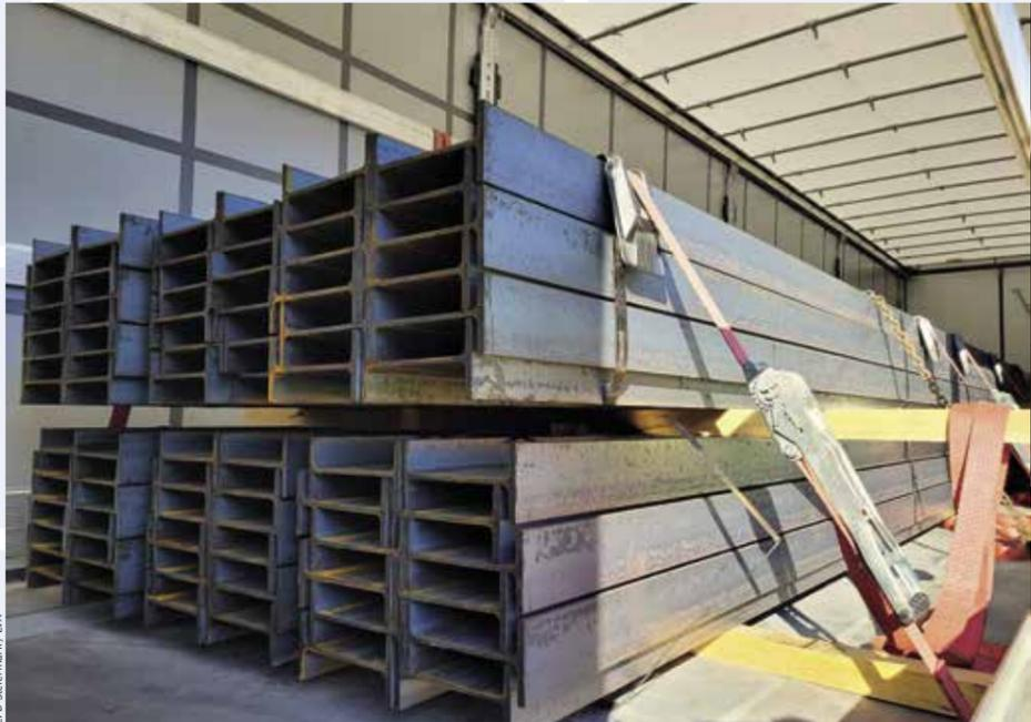
**NICHT AUSREICHEND** Ein mit 22 Tonnen Stahlträgern beladener Lkw hatte zu wenig Zurrgurte verwendet.
